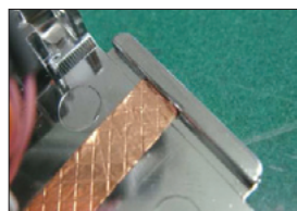
4. 将铜箔粘贴至外壳卡口处以防止脱落
