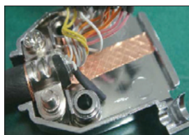
3. 加上外壳,并将铜箔粘贴在外壳
